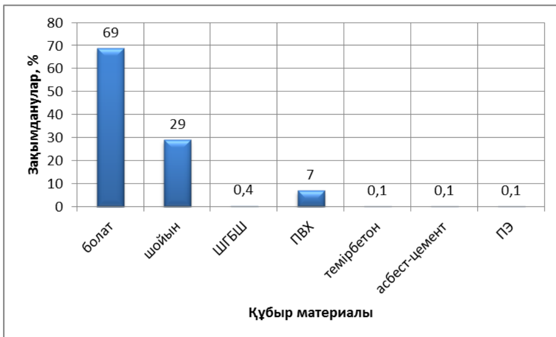
Б. 6 Сурет – Құбыр материалына байланысты су ағып кетуімен сипатталатын зақымданулар, %
